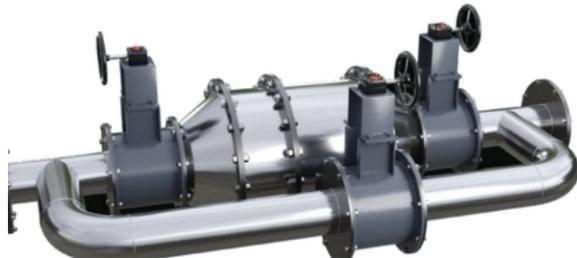
O filtro de partículas diesel CatEMission DPF é um componente essencial para a redução de partículas nos gases de escape do motor diesel. Ele opera por filtração física, empregando um projeto de filtro de "fluxo de parede", capturando efetivamente partículas de fuligem nas quais o catalisador de oxidação diesel DOC não é oxidado.
